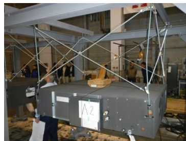
重量機器振止め支持耐震検証
