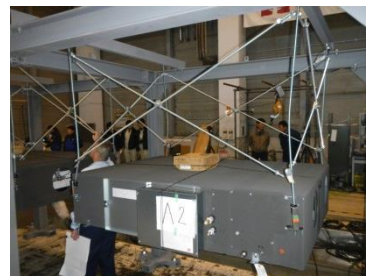
重量機器振止め支持耐震検証
