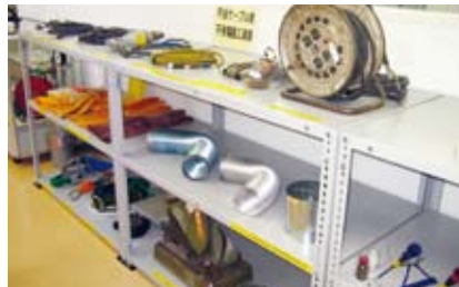
不良ケーブル類・不良電動工具類
