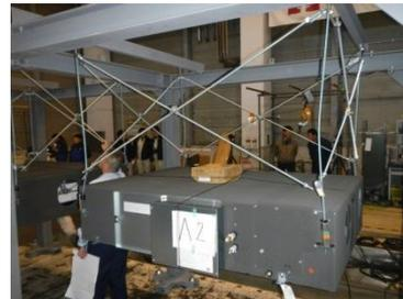
重量機器振止め支持耐震検証
