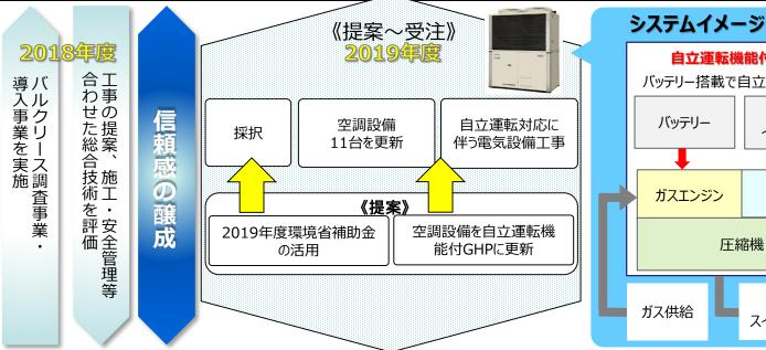
商用電力 自立運転機能付GHP 停電 バッテリー搭載で自立運転が可能 系統連系 電源切替盤 バッテリー インバーター 停電後 自立回路側 に切り替わる
